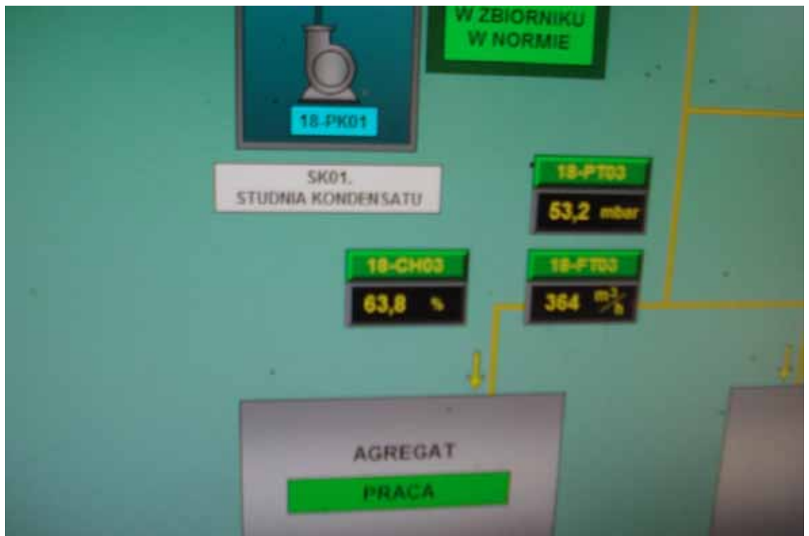
Foto: Fragment ekranu monitora z aktualnymi (chwilowymi) wskazaniami parametrów produkcji: np. 63,8% - aktualny poziom stężenia metanu
