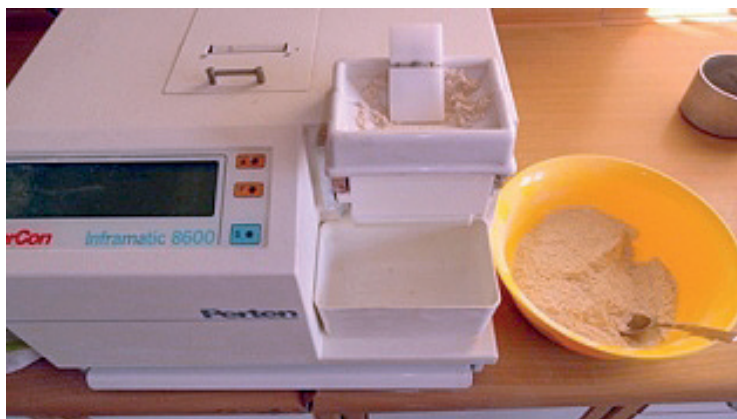
Zdjęcie nr 3. Aparat do mierzenia parametrów wilgotności, białka, glutenu, sedymentacji.
