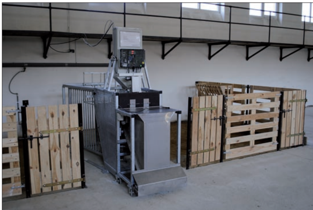
ZD Pawłowice - Stacja oceny tryków (sterowana komputerowo podwójna automatyczna stacja paszowa)
