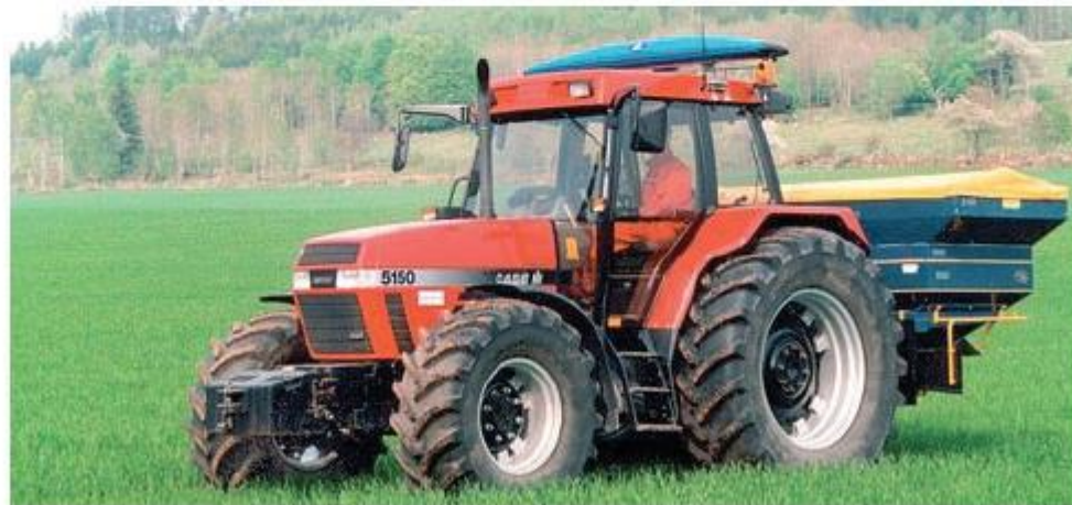
Urządzenie N-sensor zamontowane na dachu ciągnika i rozsiewanie nawozu na podstawie oceny barwy liści (łanu) (źródło: miljoforskning.formas.se )
