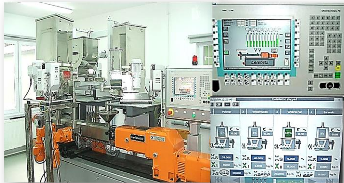
Nowoczesna wyciączarka dwuślimakowa Leistriz MICRO 27 GL/GG-44D
