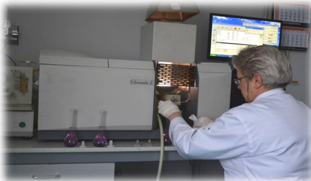
Spektrometr absorpcji atomowej z atomizacją w płomieniu – FAAS (GBC) wykorzystywany m. in. do oznaczania zawartości magnezu, wapnia, rtęci, potasu, cynku itp.
