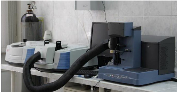
FTiR i TGA sprzężone z ATR, NICOLET IS10
