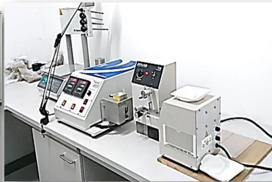
Wyciączarka laboratoryjna z granulatorem oraz mikrowtryskarką LME Dynisco – Laboratory Mixing Extruder
