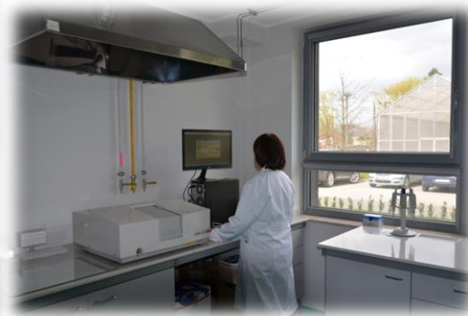
Spektrofotometr UV-Vis (GBC) do analizy zawartości związków biologicznie czynnych
