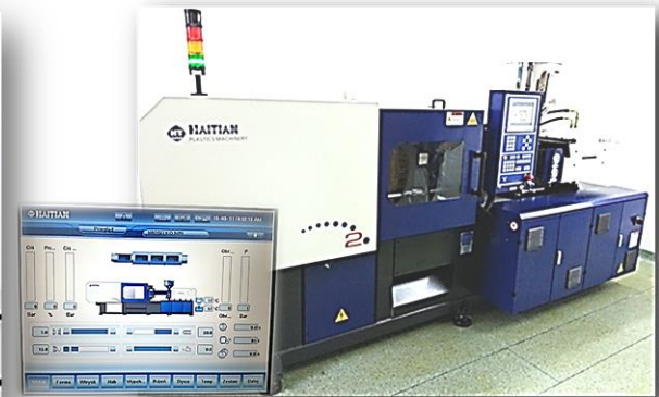
Wtryskarka hydrauliczna Haitian Mars II MA600 Eco
