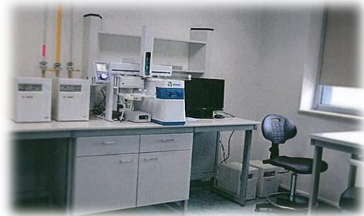
System Attana Cell 200 do badania oddziaływań cząsteczkowych na powierzchni komórki
