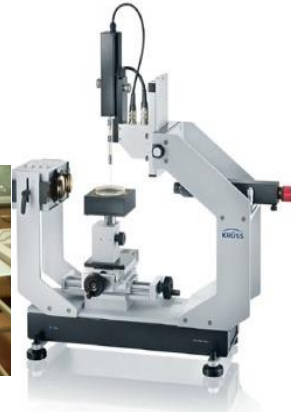
Goniometr DSA30S, Kruss GmbH badanie energii powierzchniowej
