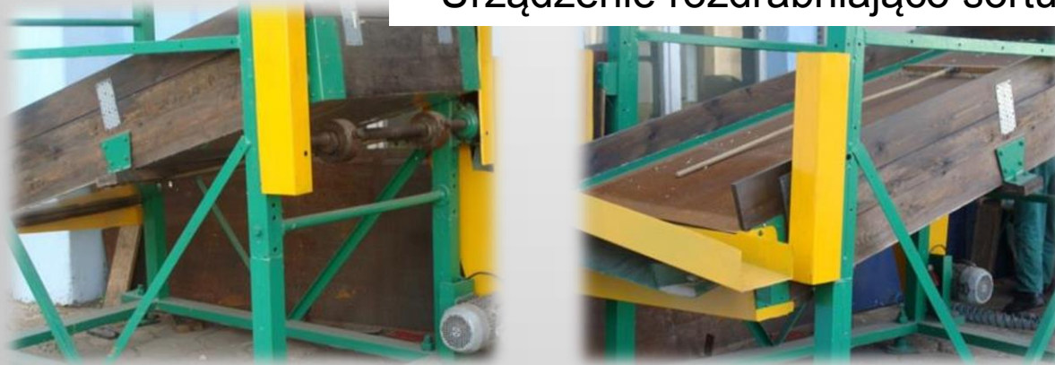
Urządzenie rozdrabniająco sortujące paździerze konopne.
