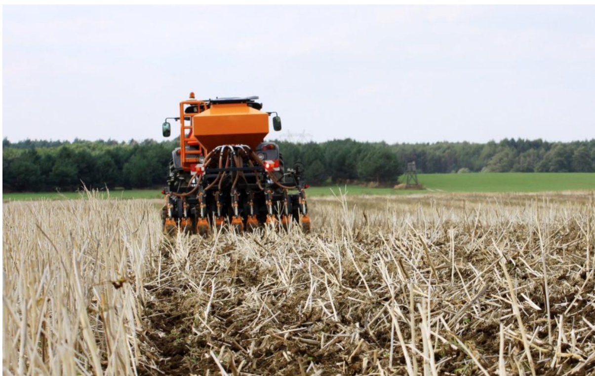
Fot. 2. Siew pasowy w RZD Kępa-Osiny z równoczesną aplikacją nawozów (fot.: A. Nieróbca)
