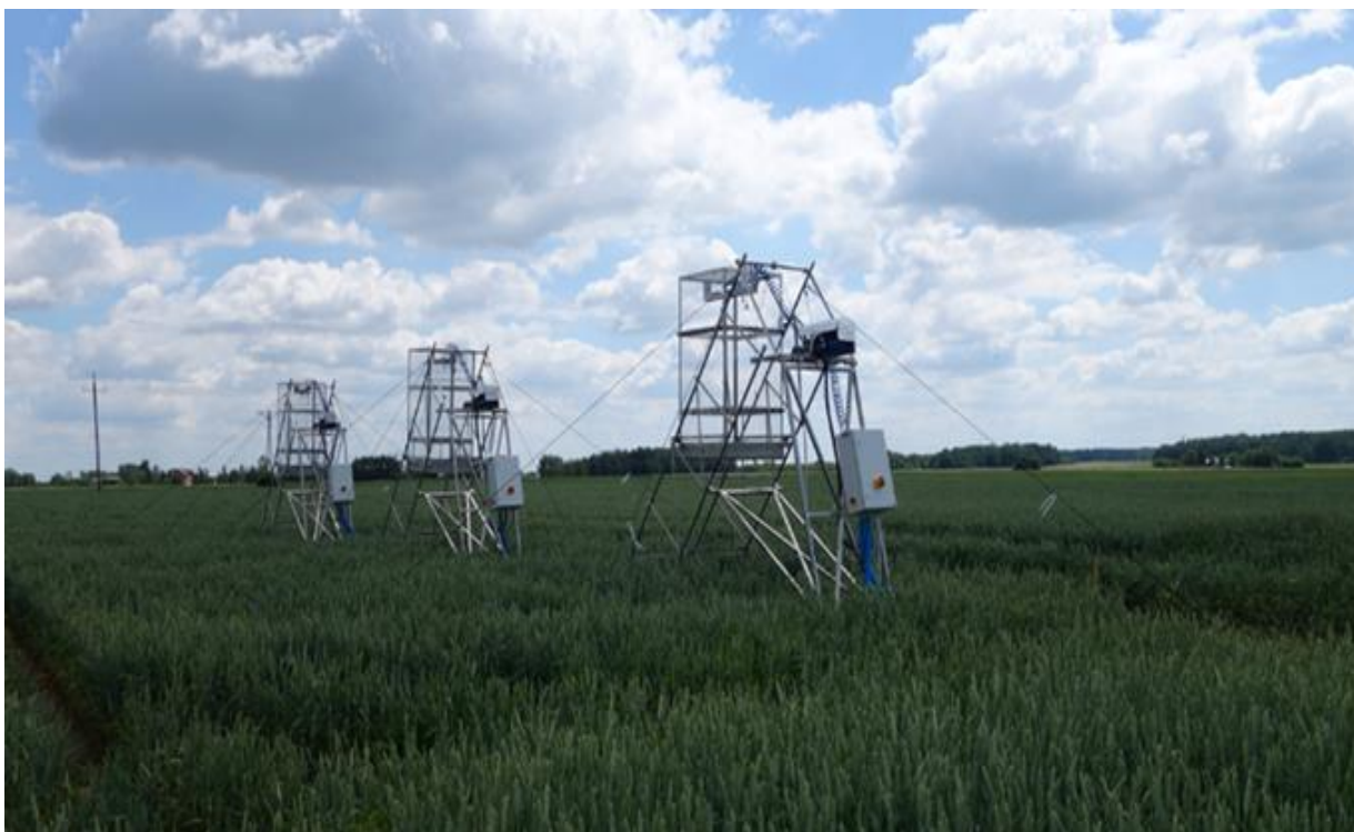
Fot. 6. System do ciągłych pomiarów emisji podtlenku azotu i dwutlenku węgla zainstalowany w Rolniczym Zakładzie Doświadczalnym IUNG-PIB w Grabowie (fot. J. Kozyra)
