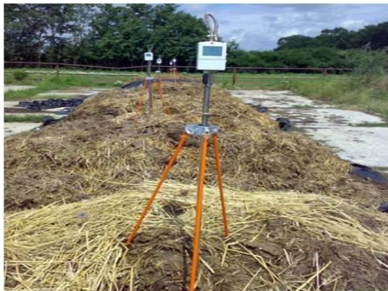
Fot. 3. Pomiary temperatury przyzm sondami termicznymi prototypowa aparatura wyposażona we własne zasilanie i Data Logger (fot. Jacek Walczak)
