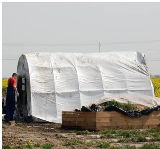
Fot. 2. Pryzma obornika pod tunelem przed pomiarem emisji metodą „aerodynamic tunnel” (widok zewnętrzny tunelu) (fot. Jacek Walczak)
