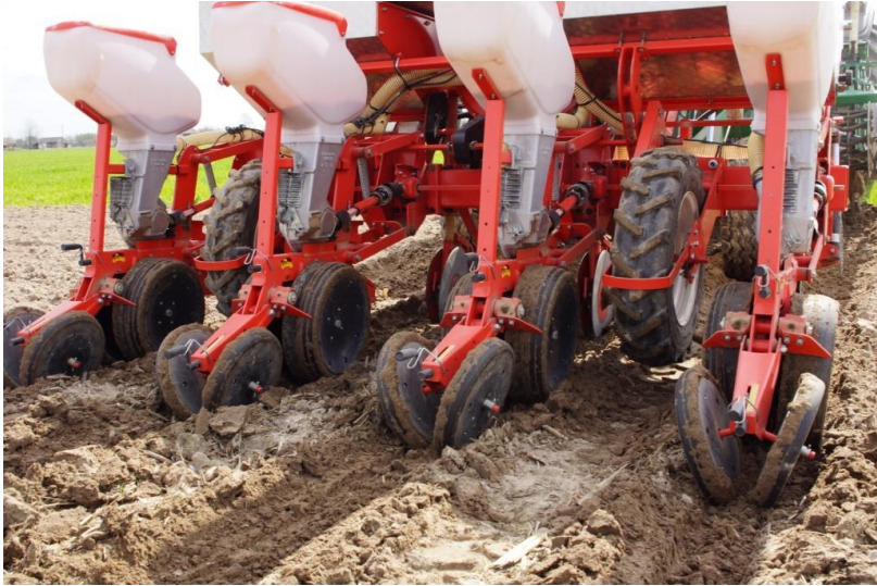
Fot. 2. Aplikacja doglebowa nawozu podczas siewu – RZD IUNG w Grabowie
