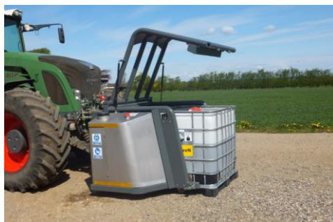
Fot.11. Wymiana pojemnika z kwasem (1 pojemnik=1000 l= 1840 kg kwasu siarkowego) (fot. Henning Foged, enAgro Dania).
