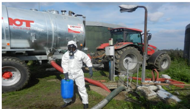
Fot. 4. Kombinezon ochronny stosowany przy pracy z kwasem siarkowym (fot. Mateusz Sękowski)
