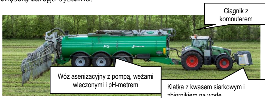
Fot. 9. Wóz asenizacyjny z oprzyrządowaniem do zakwaszania gnojowicy „na polu” . (fot. Henning Foged, enAgro).
