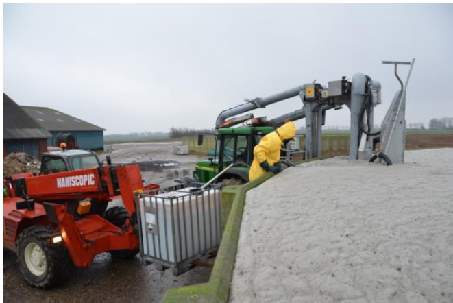
Fot. 8. Zdjęcie z katalogu firmy ØRUM-Smeden z Danii produkującej sprzęt do zakwaszania gnojowicy w zbiornikach
