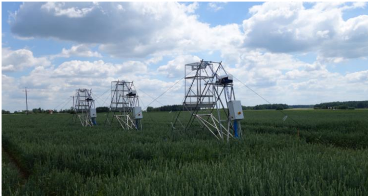
Fot 1. Stacja bazowa systemu monitoringu wilgotności gleby oraz parametrów ładu w RZD Kępa-Osiny oraz system pomiarów wymiany gazowej pomiędzy ziemią a atmosferą w RZD Grabów
