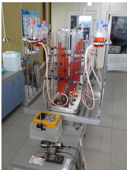
Fot. 2. Stanowisko do badań eudiometrycznych
